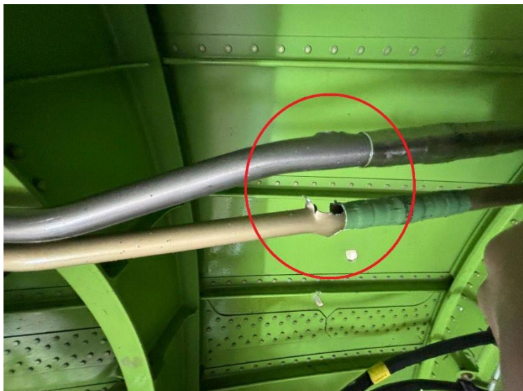
Рис. 13. Гидравлическая система 1 – Поврежденная трубка
