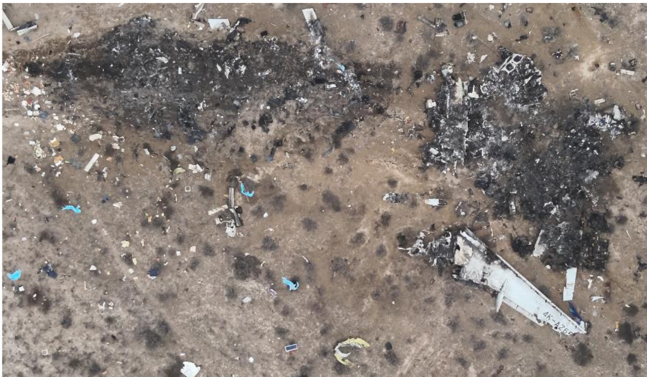
Рис. 5. Основной очаг пожара (правое крыло, носовая и центральная части фюзеляжа, центроплан и левое крыло)
