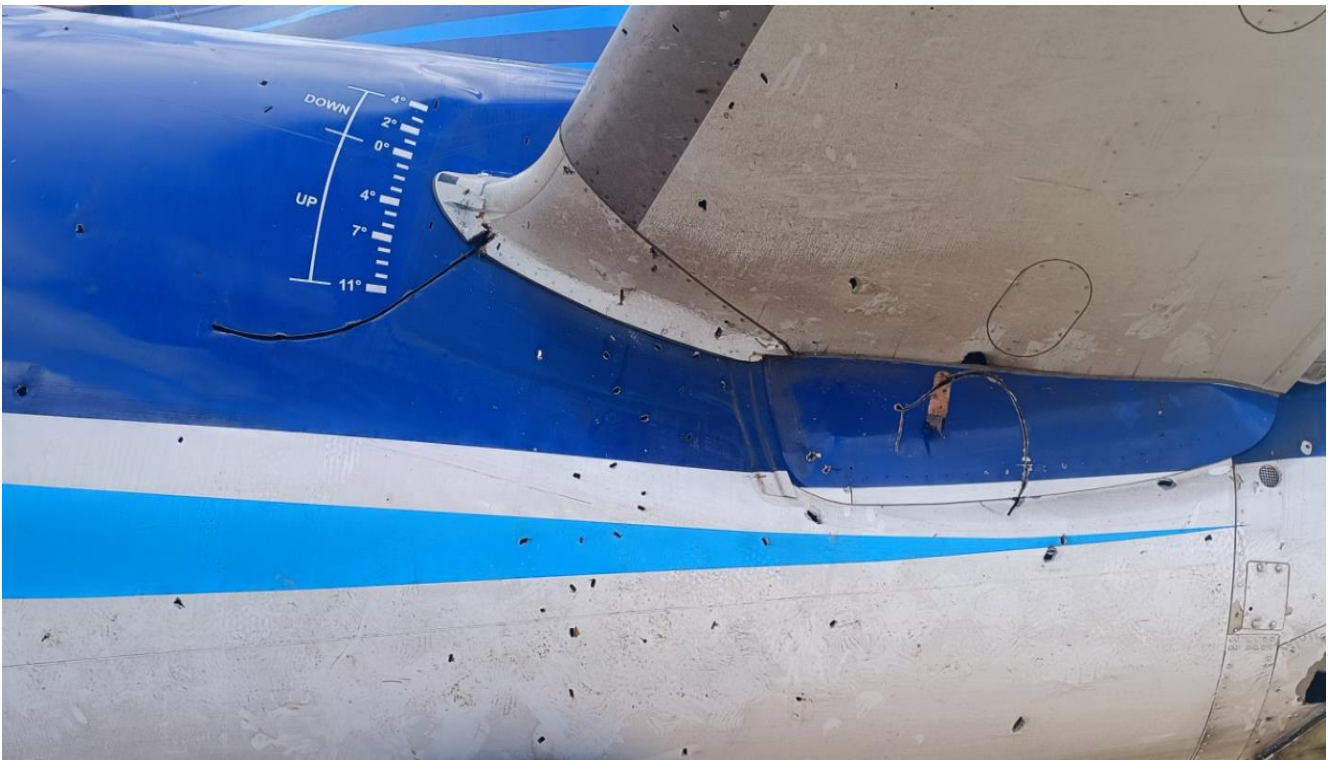
Рис. 10. Повреждения левой стороны хвостовой части
