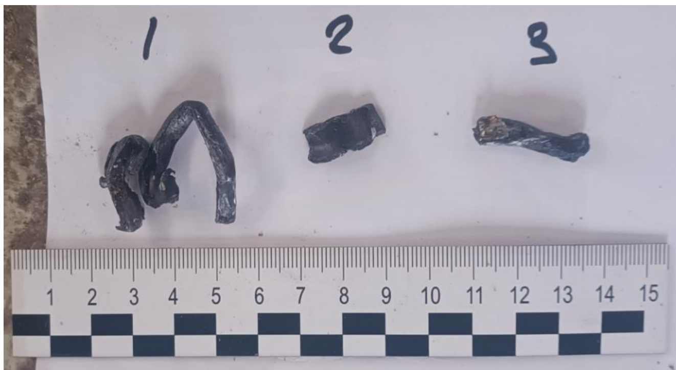
Рис. 22. Часть посторонних металлических объектов, извлеченных из отсека гидросистемы № 3 и механизма управления стабилизатором
