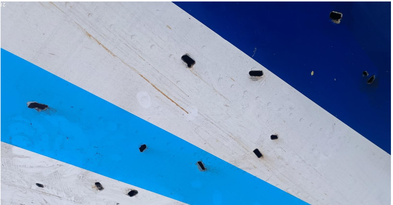
Рис. 11. Повреждения левой стороны хвостовой части
